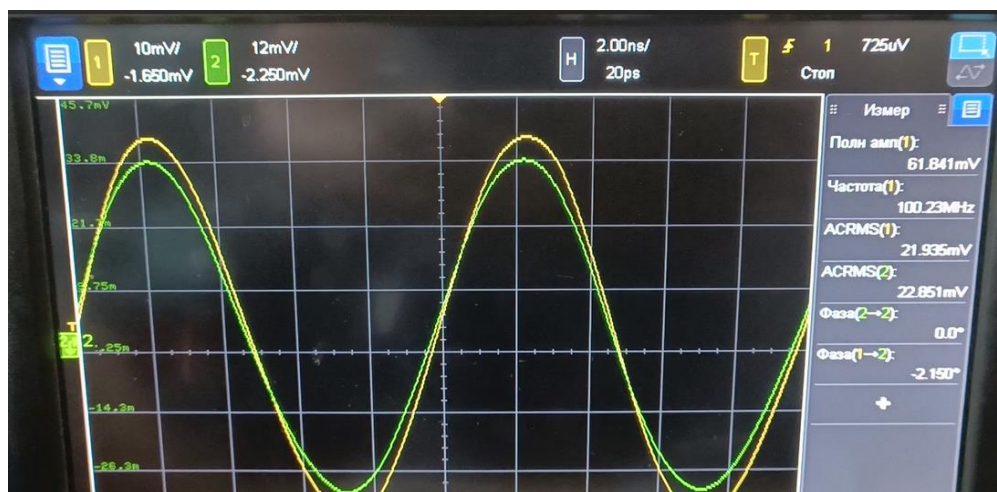
Рисунок 1. – Разность электрических длин двух кабелей при измерении с помощью осциллографа (частота генерируемого сигнала 100,23 МГц)
