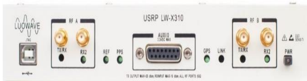
Рисунок 4. – Вид задней панели подключения приёмопередатчика SDR-LW-X310
